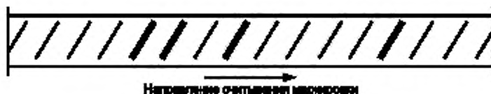
Рисунок 2 — Пример прокатной маркировки предприятия-изготовителя под номером 14
