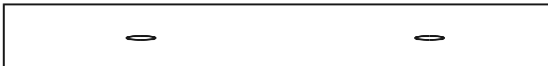
Пример 2 — две несплошности длиной по 6,4 мм
