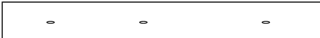
Пример 3 — три несплошности длиной по 3,2 мм
