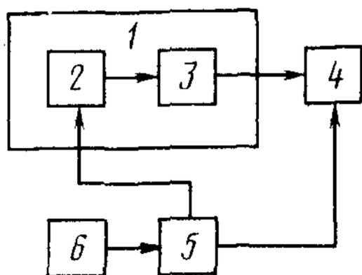
1—светозащитная камера; 2—испытуемый индикатор; 3—фотоприемник; 4—осциллографический измеритель временных интервалов; 5—коммутирующее устройство; 6—источник питания
