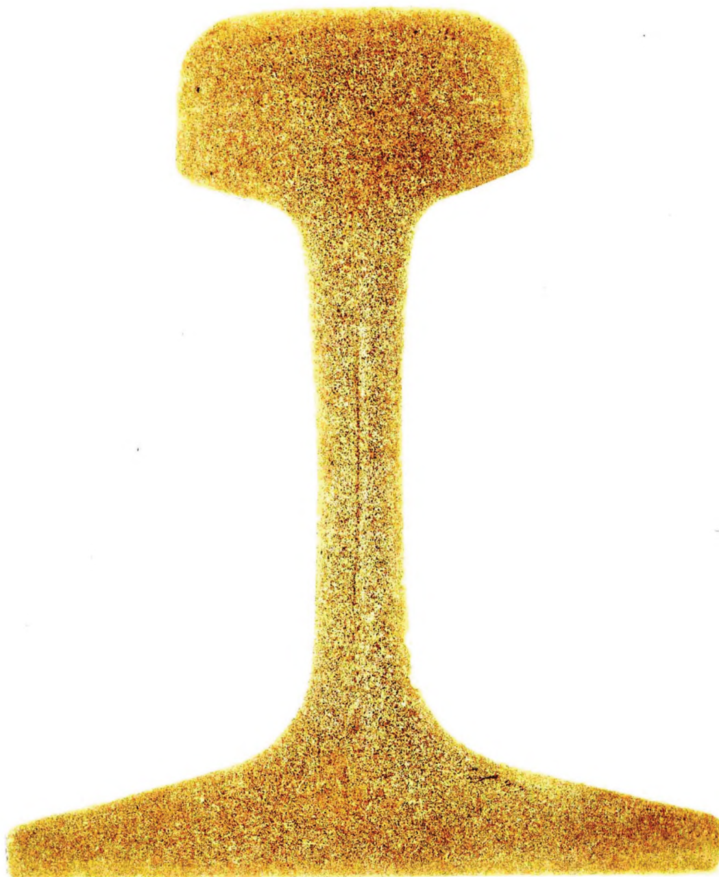
Рисунок И.13 — Ликвационные полосы (серный отпечаток)
