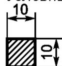
— поперечное сечение образца; длина образца от 55 до 60 мм.
