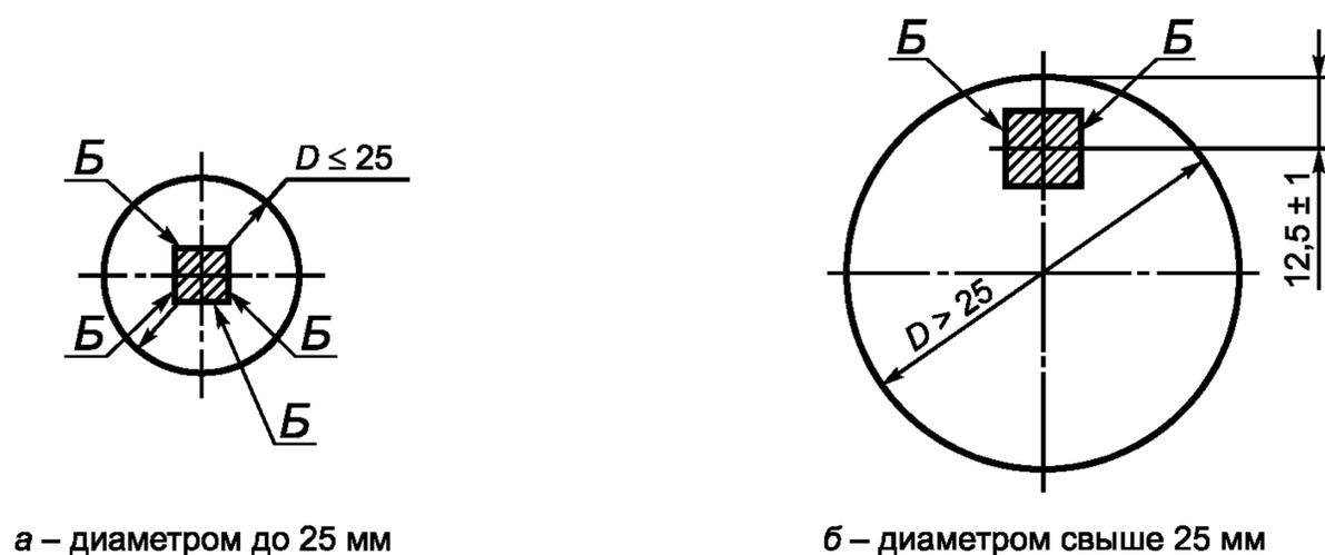
Рисунок Д.1 — Металлопродукция круглого сечения
