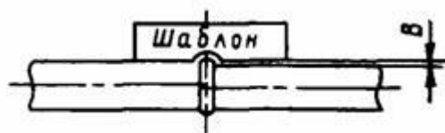
Рис. 11. Схема определения смещения кромок стыкуемых труб
