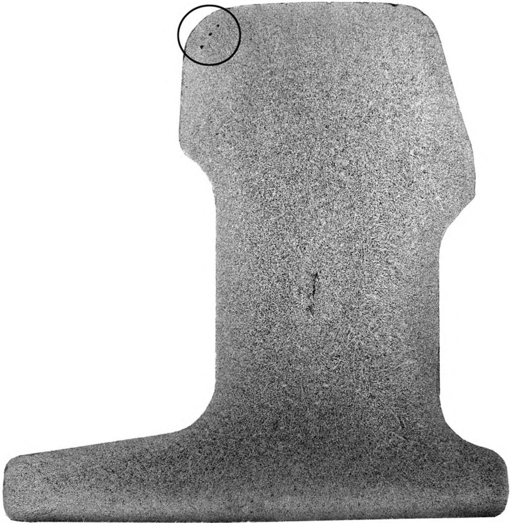
Рисунок Ж.7 — Точечная неоднородность в головке рельса
